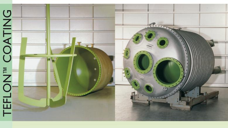
Beim Spritz-Sinter-Verfahren (Airless- und Druckluftverfahren) arbeitet Gutbrod mit Teflon™ Coating. Die Beschichtung wird aufgespritzt und dann bei 220°C bis 420°C gesintert.
